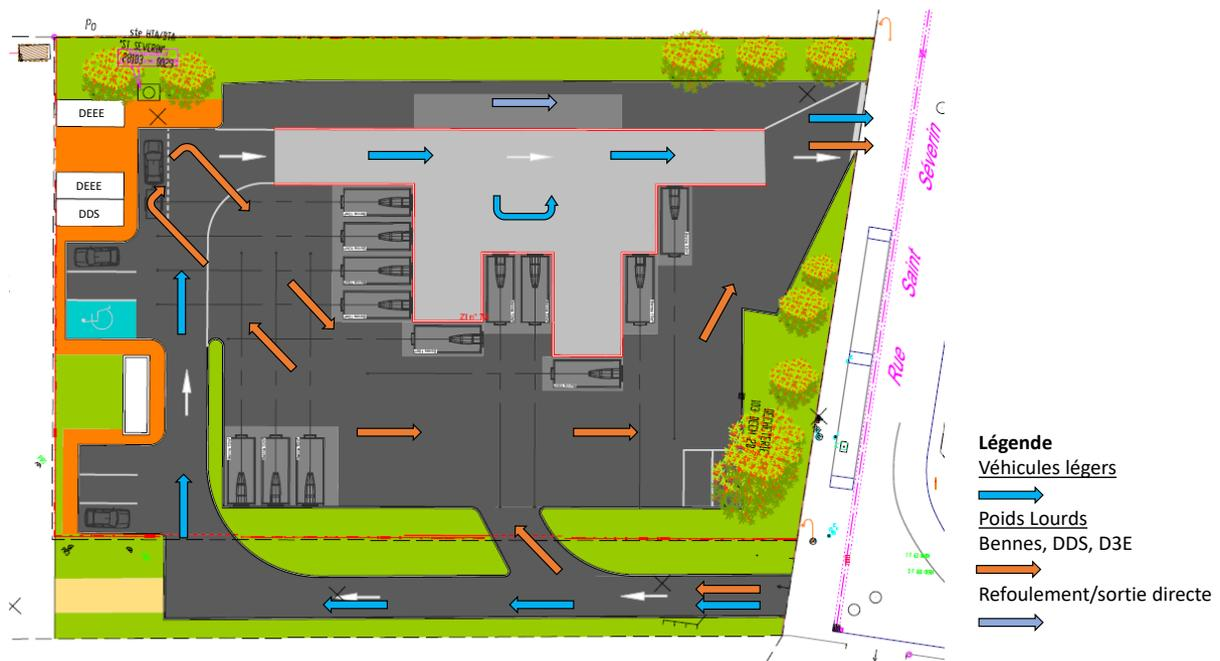
Figure 4 : Plan de masse et sens de circulation PL et VL
